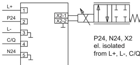
**Exemple de raccordement Analogique avec sortie stabilisée**
