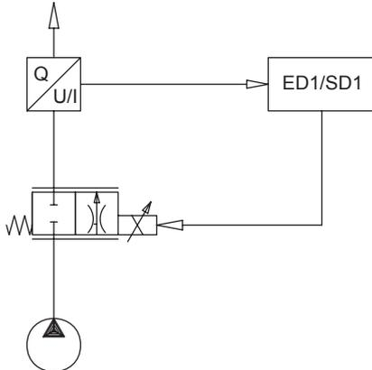
Un tel système permet de satisfaire à de hautes exigences dynamiques et statiques. On peut utiliser n'importe quelle valve proportionnelle avec une arête de commande active.
