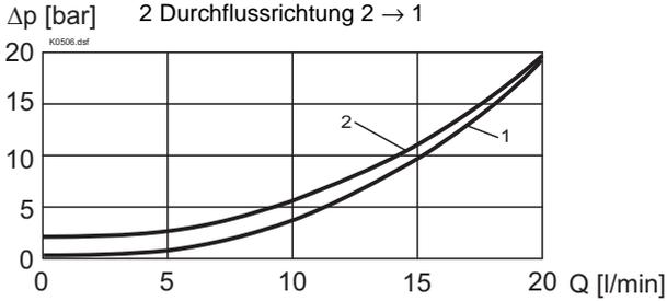
$\Delta p = f(Q)$  Druckverlust-Volumenstrom-Kennlinie
