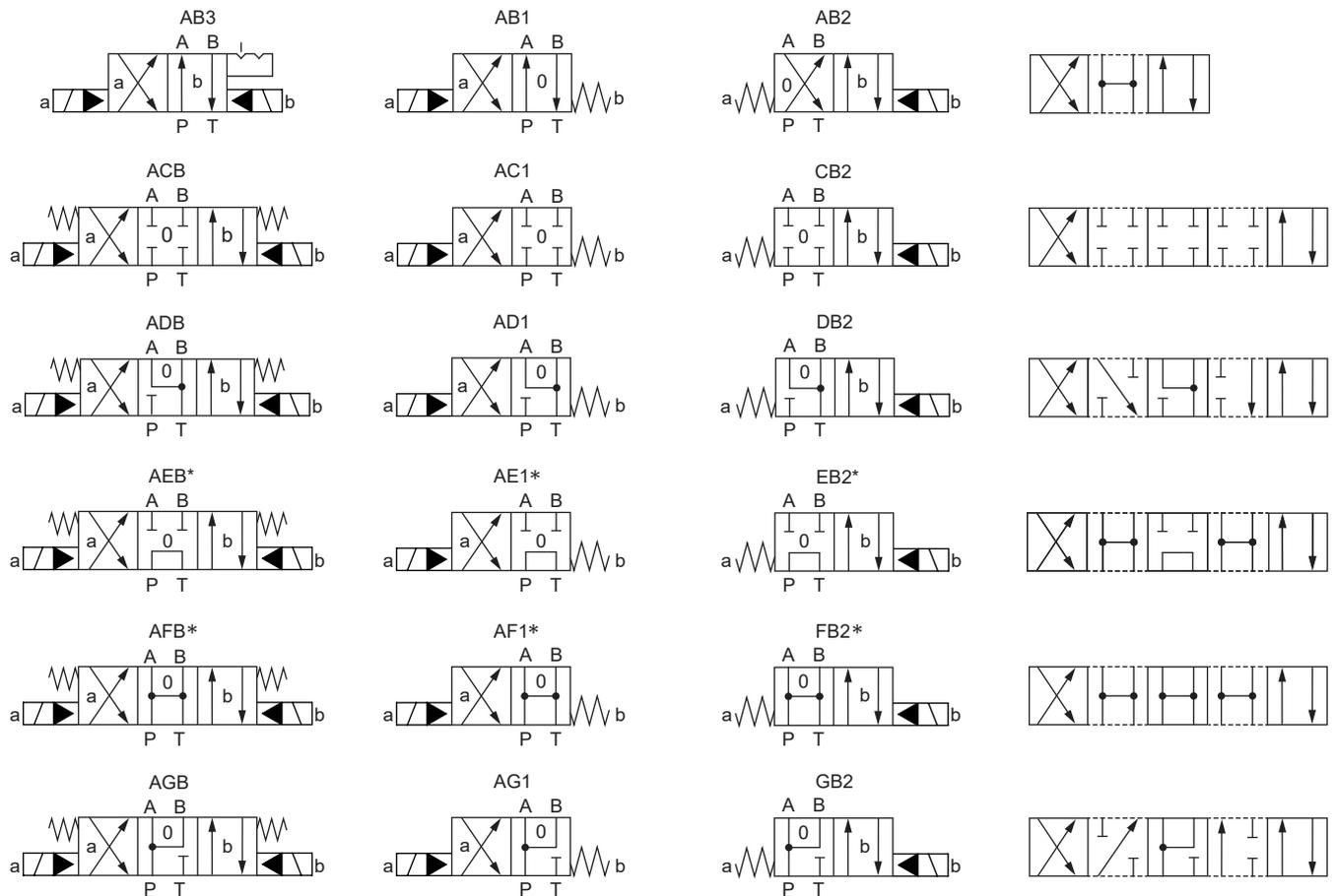
\* Wenn in der Mittelstellung die Anschlüsse P und T verbunden sind, wird bei interner Steuerölführung (ti/pi) standardmässig eine Staudruckpatrone eingebaut. Wird auf dieses Vorspannventil verzichtet (0 gemäss Typenschlüssel) ist sicher zu stellen, dass ein Vorsteuerdruck von mindestens 4 bar vorhanden ist. Die Druckdifferenz der Staudruckpatrone und des Hauptventils ist (siehe Kennlinien) zu einem Gesamtwert zu addieren. Vorsteuerart xi ist mit Staudruckpatrone nicht lieferbar.
