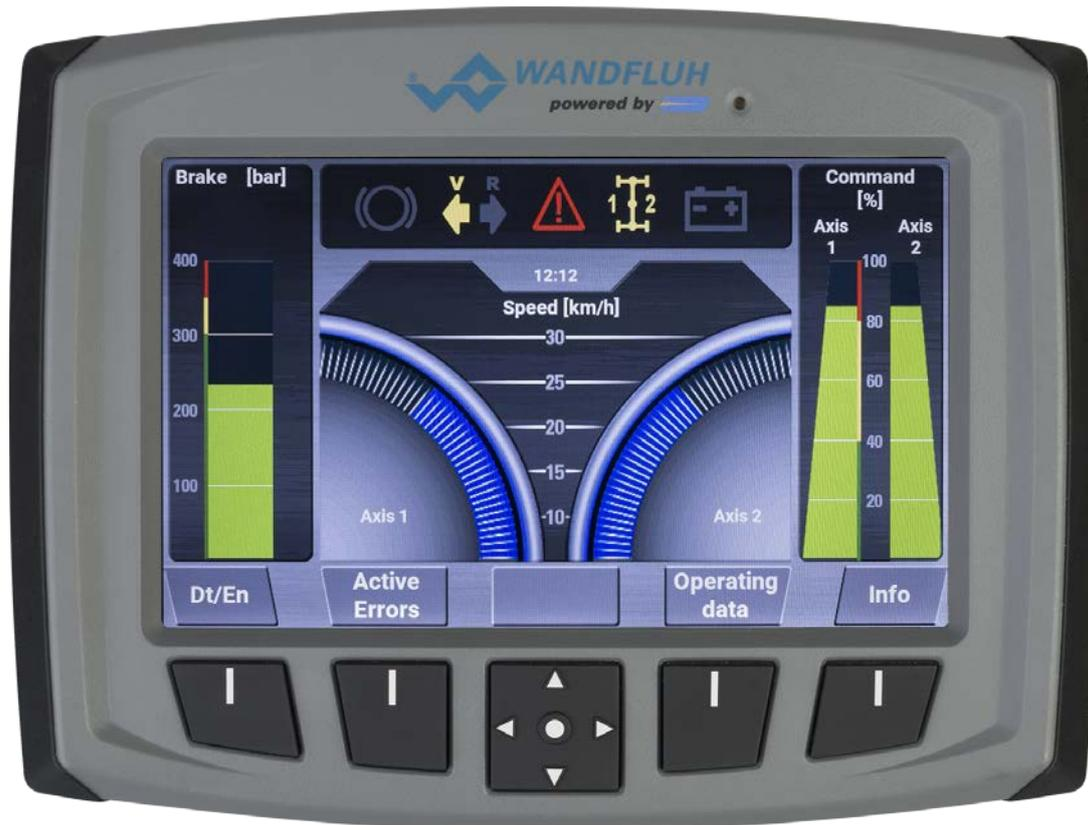
Abb. PME – Programmierbare Mobile Elektronik von Wandfluh
