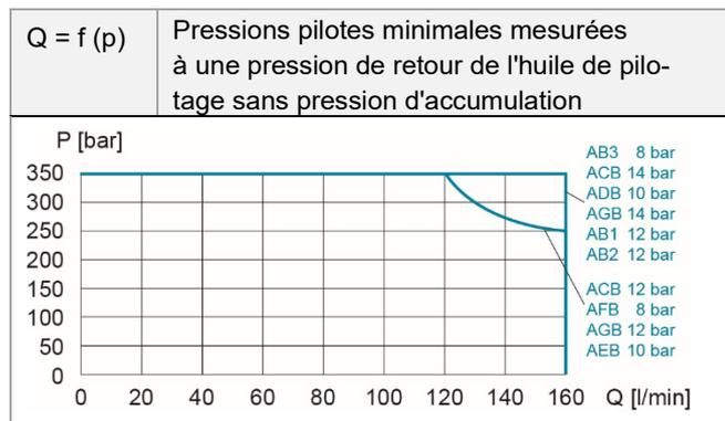
Différents types de pistons (mesurés à une pression pilote de xx bar)
