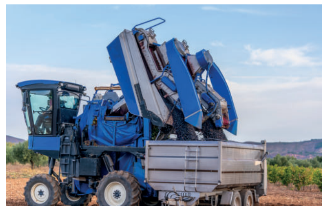
Weintraubenvollernter , selbstfahrend beim Entleeren der Weintrauben
