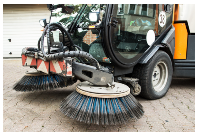
Kompaktkehrmaschine mit angehobenen Seitenbesen im Transportmodus
