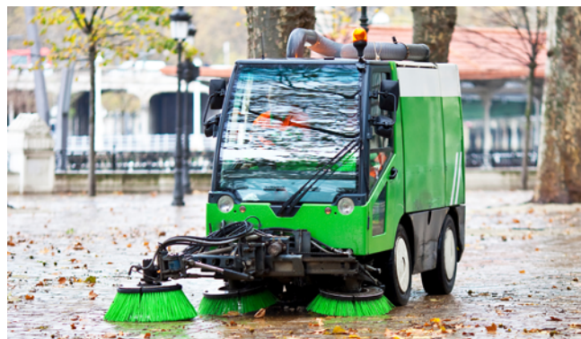
Kompaktkehrmaschine im Arbeitseinsatz
