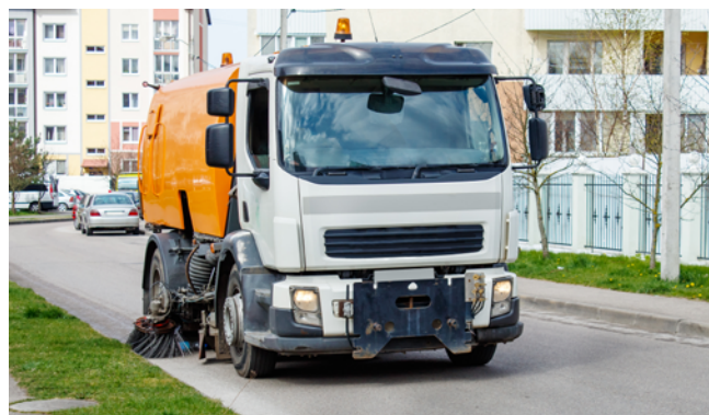
LKW-Aufbaukehrmaschine im Arbeitseinsatz
