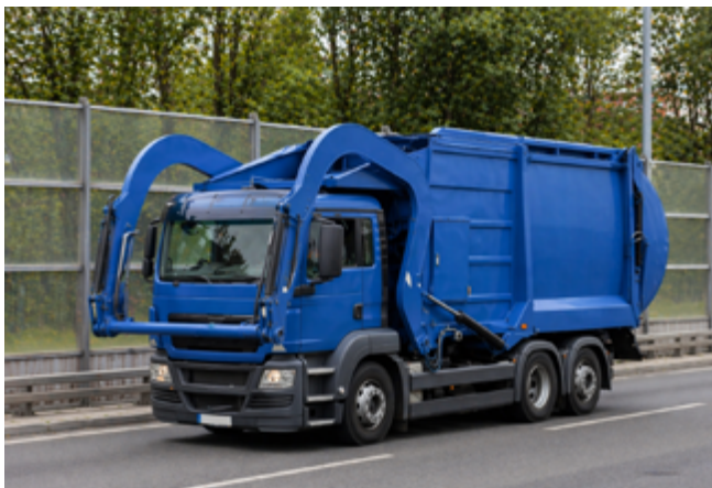
Frontlader , frontbeladenes Abfallsammelfahrzeug
