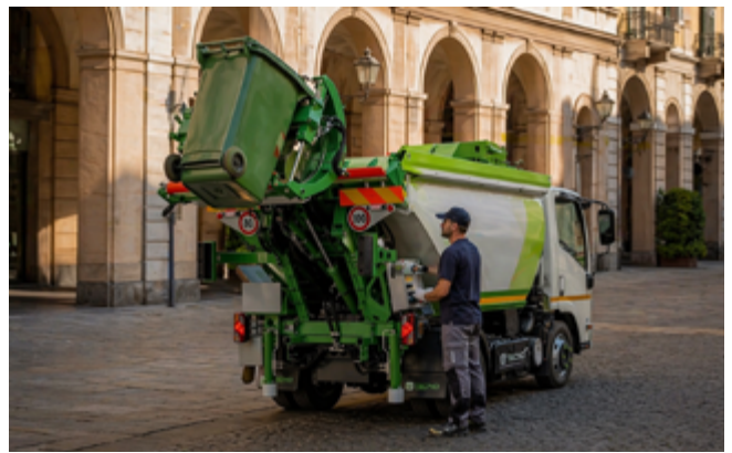
Minihecklader , heckbeladenes Kompakt-Abfallsammel-fahrzeug im Arbeitseinsatz
