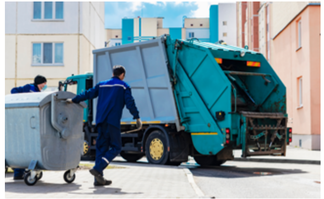
Hecklader , heckbeladenes Abfallsammelfahrzeug im Arbeitseinsatz
