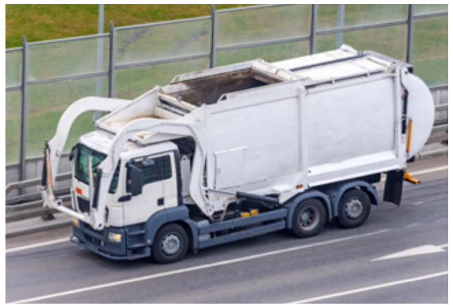
Frontlader , frontbeladenes Abfallsammelfahrzeug im Transportmodus
