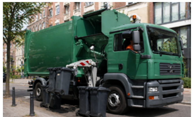
Seitenlader , seitenbeladenes Abfallsammelfahrzeug
