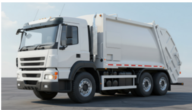
Hecklader , heckbeladenes Abfallsammelfahrzeug
