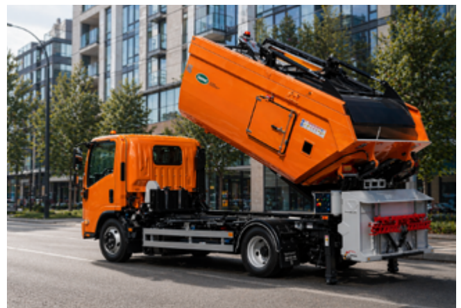
Minikecklader , heckbeladenes Kompakt-Abfallsammelfahrzeug
