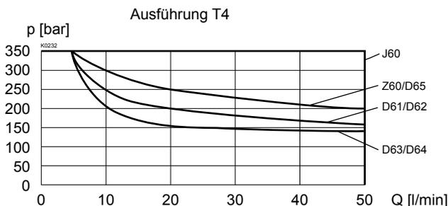
$\Delta p = f(Q)$  Druckverlust-Volumenstrom-Kennlinie
